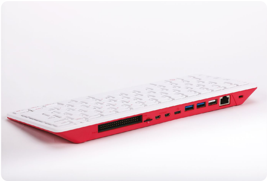
▲ Abbildung 1-17: Die Anschlüsse befinden sich an der Rückseite des Raspberry Pi 400
