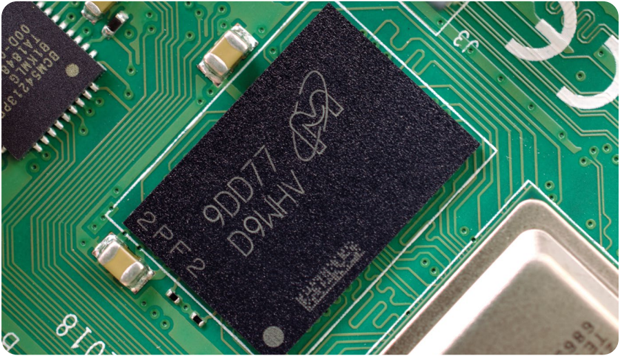
▲ Abbildung 1-3: Das ist der Arbeitsspeicher (RAM) des Raspberry Pi
