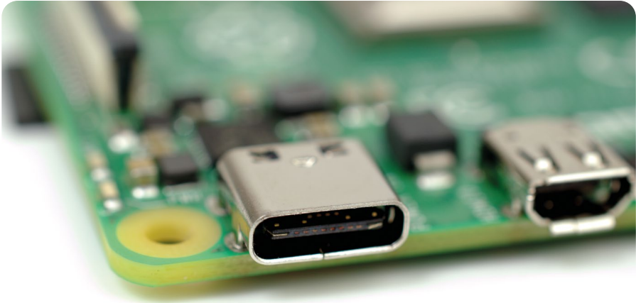
▲ Abbildung 1-11: USB-C Stromanschluss des Raspberry Pi
