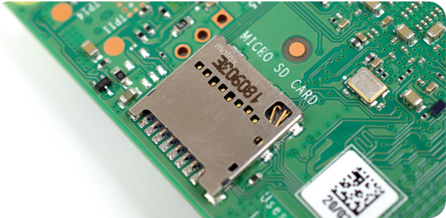
← Abbildung 1-15: microSD-Karten-Anschluss des Raspberry Pi
