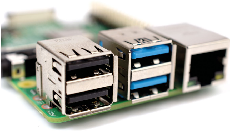
▲ Abbildung 1-6: USB-Anschlüsse des Raspberry Pi
