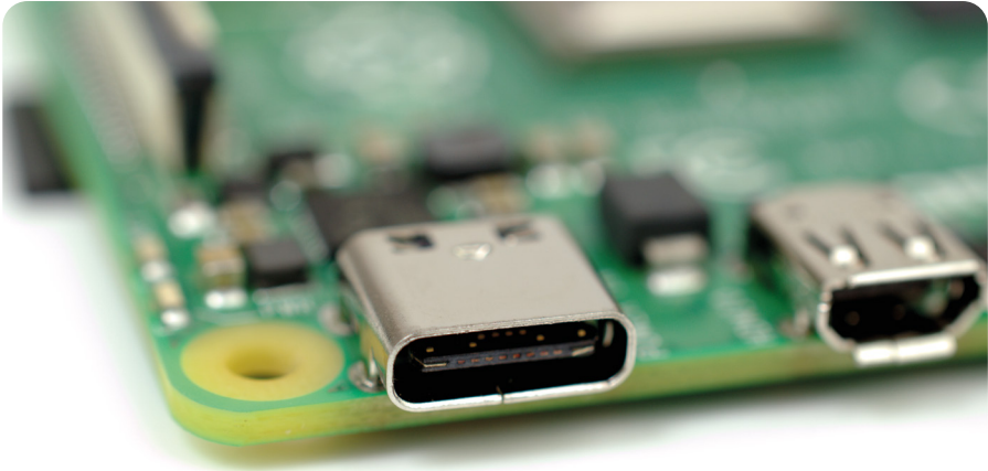
▲ Figura 1-11: Porta de alimentação USB Tipo C do Raspberry Pi
