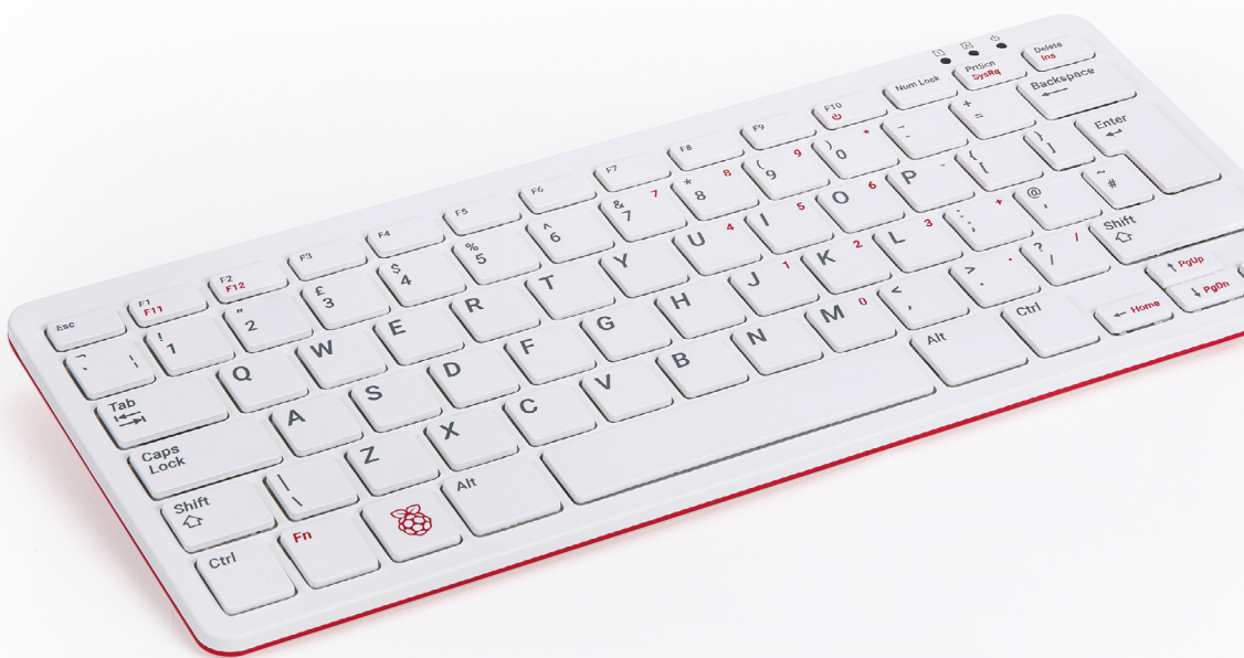
▲ Figura 1-16: O Raspberry Pi 400 tem um teclado integrado
