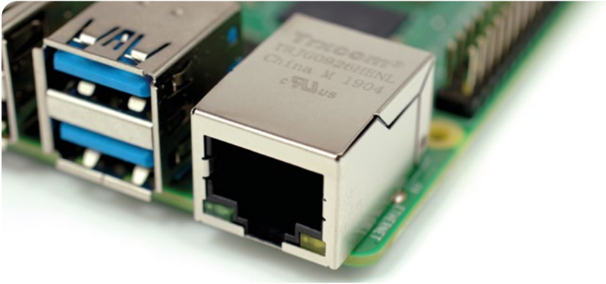
▲ 図 1-7: Raspberry Pi のイーサネットポート
