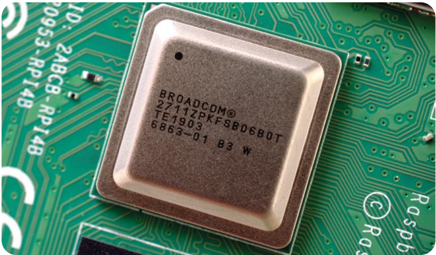
▲ 図 1-2: Raspberry Pi のシステムオンチップ (SoC)
