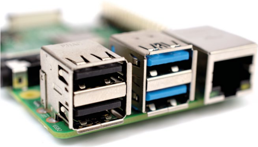
▲ 図 1-6: Raspberry Pi の USB ポート
