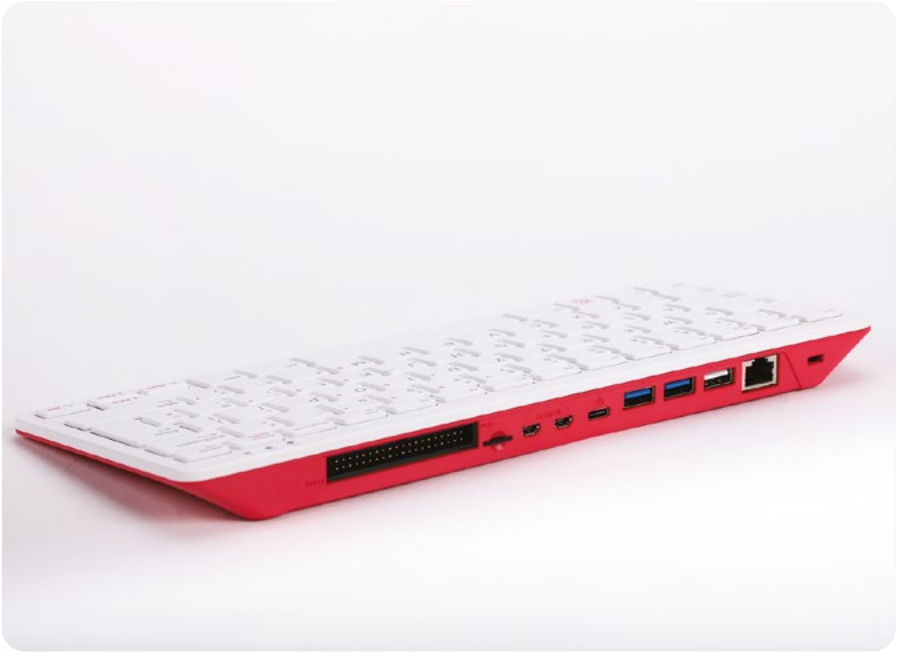
▲ 図 1-17: Raspberry Pi 400 背面のポート
