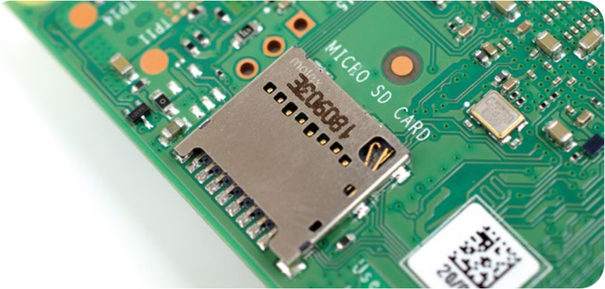
▲ 図 1-15: Raspberry Pi の microSD カードコネクタ
