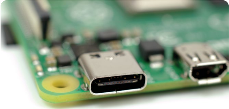
▲ 図 1-11: Raspberry Pi の USB Type-C 電源ポート
